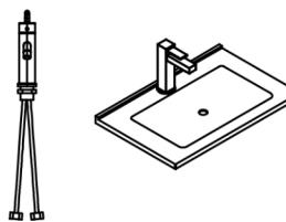
Installation du robinet : Installez le robinet sur le lavabo. Assurez-vous que tous les raccords sont correctement serrés sans fuite d'eau.
